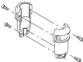
El cabezal de la bomba y la brida de montaje del motor están fabricados en una pieza (fundición). El cabezal de la bomba es un componente independiente (acero inoxidable). El cabezal de la bomba posee un tapón de cebado y un tornillo de purga de aire combinados de 1/2".
